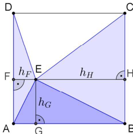
Nun gilt  $\overline{AG} \cdot \overline{GB} = h_F \cdot h_H = \frac{1}{2}h_G \cdot 2h_G = h_G^2$ . Nach der Umkehrung des Höhensatzes ist ein Dreieck rechtwinklig mit rechtem Winkel bei  $C$ , wenn für die Höhenabschnitte  $q$  und  $p$  zur Höhe  $h$  von  $C$  die Gleichung  $q \cdot p = h^2$  gilt.
