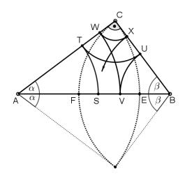
Wegen 0 < x < c trifft der letzte Kreisbogen um B die Strecke  $\overline{AB}$  in einem inneren Punkt Y mit  $|\overline{BY}| = c - x = c - |\overline{AS}|$ . Daher folgt  $|\overline{AY}| = c - |\overline{BY}| = c - (c - x) = x = |\overline{AS}|$ , weswegen Y = S sein muss. Also führt der sechste Kreisbogen wieder zu S.
