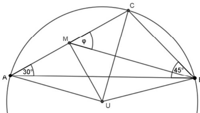
Nach dem Satz vom Mittelpunktswinkel ist der Mittelpunktswinkel  $\sphericalangle CUA$  zur Sehne  $\overline{AC}$  doppelt so groß wie der Umfangswinkel  $\sphericalangle CBA$ . Somit gilt  $\sphericalangle CUA = 2 \cdot \sphericalangle CBA = 90^\circ$ . Somit ist das Dreieck  $UCA$  gleichschenkelig-rechtwinklig.
